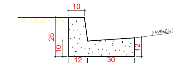
MEIO FIO COM SARJETA Medidas em cm
